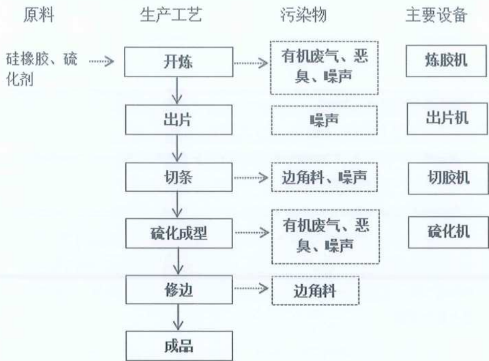
图 3.6 本项目硅胶制品生产工艺流程图
